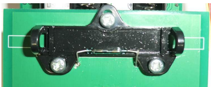
図 19 Board_C 上の軸受けとリードスイッチの位置関係
